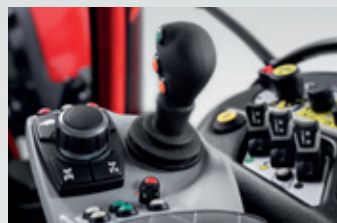
einfache Bedienung des Stufenlosgetriebes mit dem LDrive-Controller
